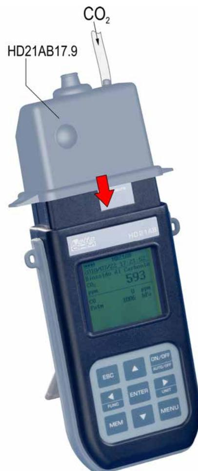
7. Quando appare l'indicazione "CALIBRAZIONE OK", premere ESC per tornare al menu di calibrazione.
